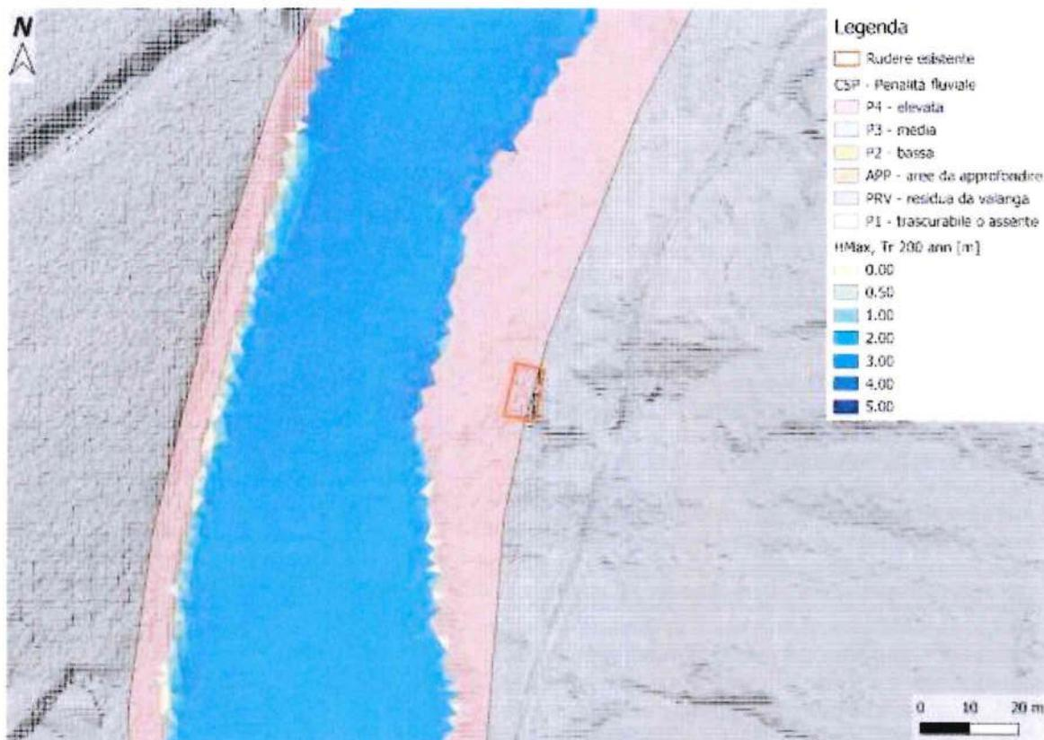
Figura 6.2 Confronto tra i risultati della simulazione per pericolosità fluviale del Sarca e la CSP fluviale
