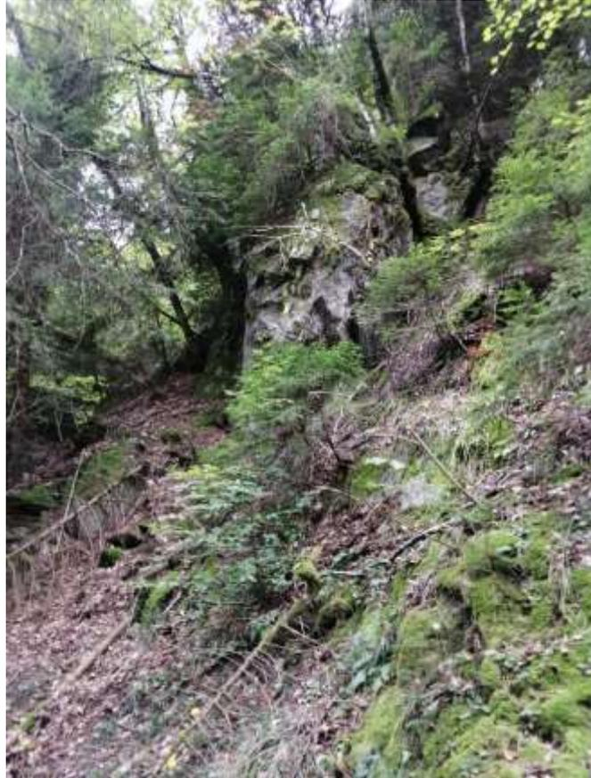
**Figura 6.9 Pareti zona Nord. Mediamente compatte ma parzialmente con blocchi con fessure persistenti**
